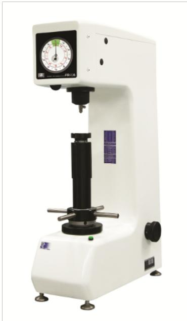
洛氏硬度计：1. 数显表面洛氏硬度计。当金属硬度层比较薄时，如用一般洛氏硬度计就会将硬度层打穿，而测不到其表面硬度层的真正硬度。这时要用洛氏表面硬度计。由于表面层较薄，人工手动打就不易控制，一般都为电动，且为数显，所以是数显表面洛氏硬度计。用于经过渗碳或渗氮的钢材、电镀层为主，以及用于想知道金属如钢材、合金钢、硬质合金表面的硬度。2. 数显洛氏、表面洛氏硬度计。能测一般的洛氏硬度，又能测表面洛氏硬度。根据压头匹配和标尺选择，可测参数为HRA□B□C□D□E□F□G□H和K□CPU数据处理。机子除配有打印机外，还有RS-232计算机接口。重庆高速钢硬度洛氏硬度计检测力洛氏硬度计是根据洛氏硬度计原理设计的洛氏硬度计。
